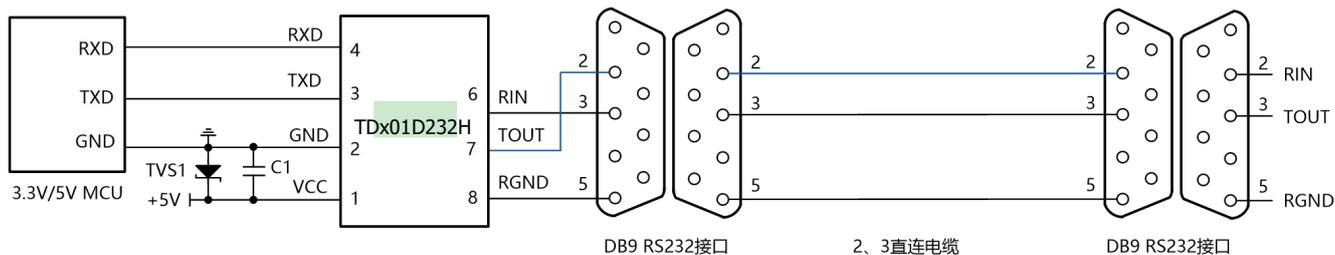
图 1. 使用 2、3 脚直连串口线
