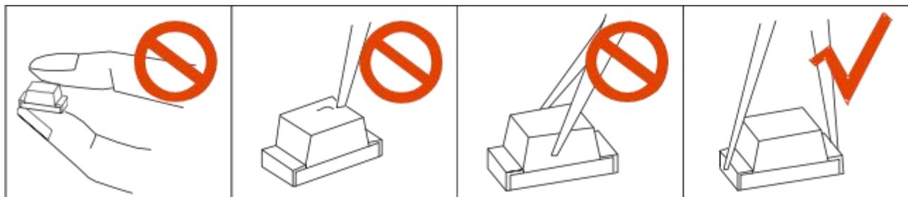
LED 的环氧树脂封装部分相当脆弱，请勿用坚硬、尖锐的物体刮、擦封装树脂部分。在用镊子夹取的时候也应当小心注意。
