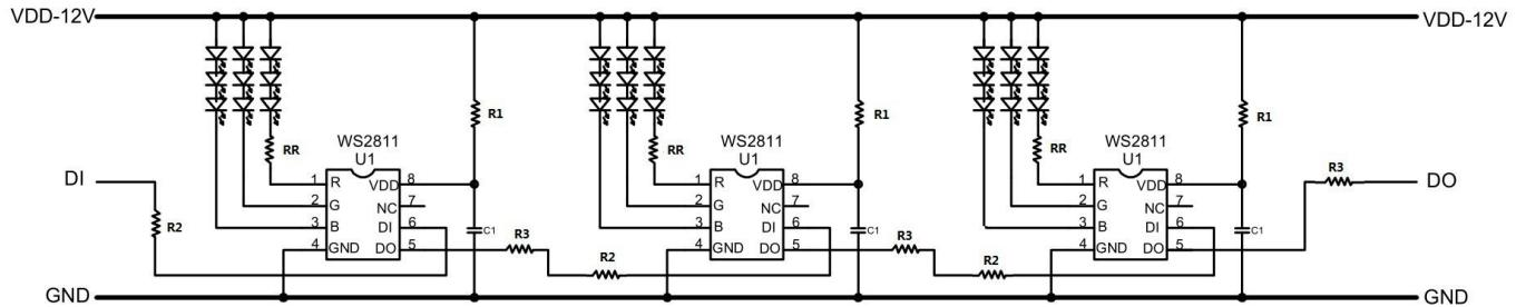
注：上图采用恒流方式，可以在电压不断下降的同时达到亮度和色温不变的理想效果。R1=3.3K 为 IC 内部 LDO 分压电阻，C1 的电容为旁路滤波电容。R2、R3 为 IC 的信号输入与信号输出提供热插拔保护和阻抗匹配的电阻，阻值在 33R 左右。
