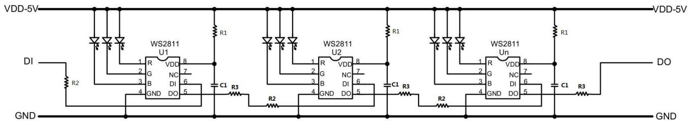
注：上图采用恒流方式，可以在电压不断下降的同时达到亮度和色温不变的理想效果。R1 电阻是为了防止电源尖峰和电源反接，在 IC 供电端（VDD）串接的一个不大于 100 欧的电阻，C1 的电容为旁路电容。R2、R3 为 IC 的信号输入与信号输出提供热插拔保护和阻抗匹配的电阻，阻值在 33R 左右。
