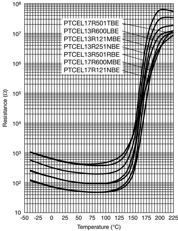
MINIMUM PTC RESISTANCE UNDER PULSED VOLTAGE
