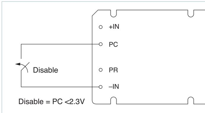
Figure 2 — Module enable/disable
