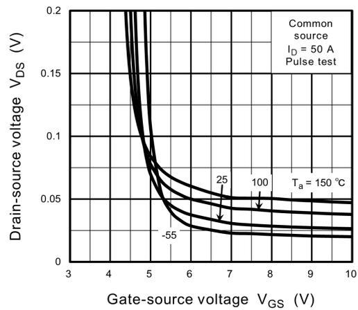
Fig. 8.4  $V_{DS} - V_{GS}$
