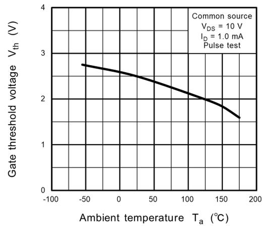
**Fig. 8.12  $V_{th} - T_a$**
