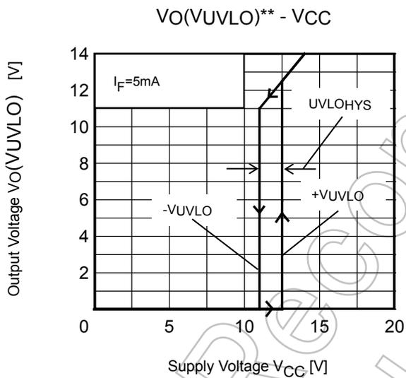
\*\*Test Circuit :  $V_O(V_{UVLO}) - V_{CC}$
