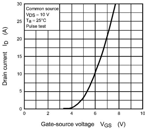
**Fig. 8.3  $I_D - V_{GS}$**
