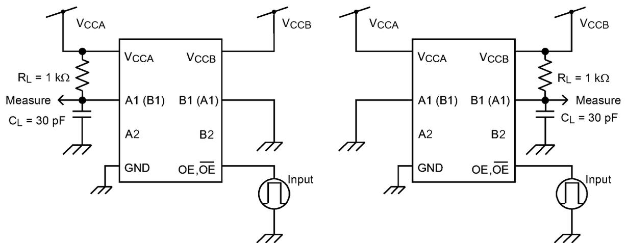
Fig. 13.2  $t_{PLZ}$ ,  $t_{PZL}$  Test Circuits
