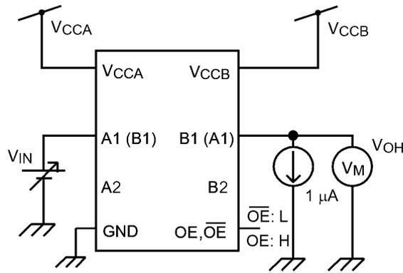
Fig. 15.1 Test Circuit
