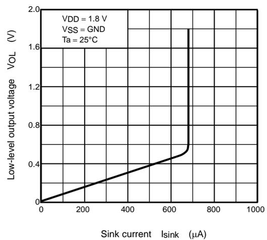
$V_{OL} - I_{\text{sink}}$
