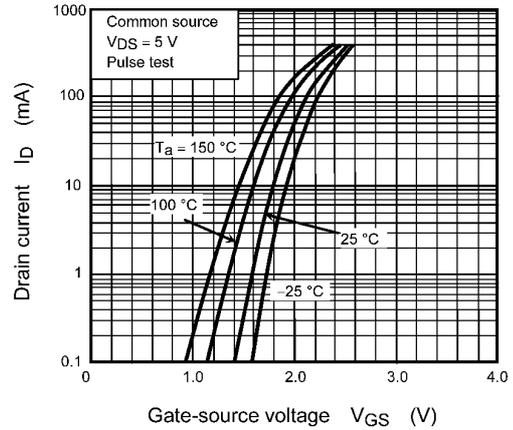
Fig. 7.2  $I_D - V_{GS}$
