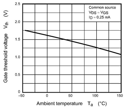
**Fig. 7.6  $V_{th} - T_a$**
