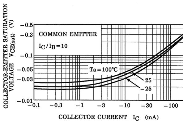
Fig. 8.3  $V_{CE(sat)} - I_C$
