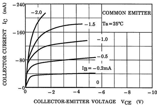
Fig. 8.1  $I_C - V_{CE}$
