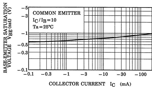
Fig. 8.4  $V_{BE(sat)} - I_C$
