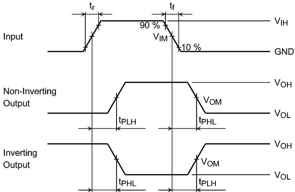
Fig. 12.8.1  $t_{PLH}$ ,  $t_{PHL}$
