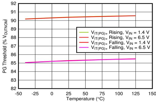
图 7-67. PG Threshold vs Temperature
