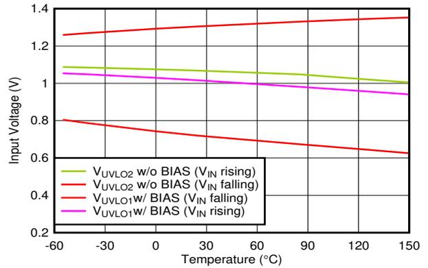
图 7-62.  $V_{IN}$  UVLO vs Temperature
