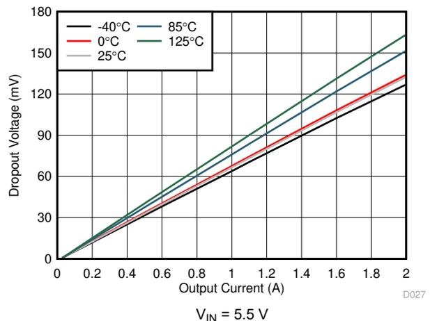
$V_{IN} = 5.5\text{ V}$
