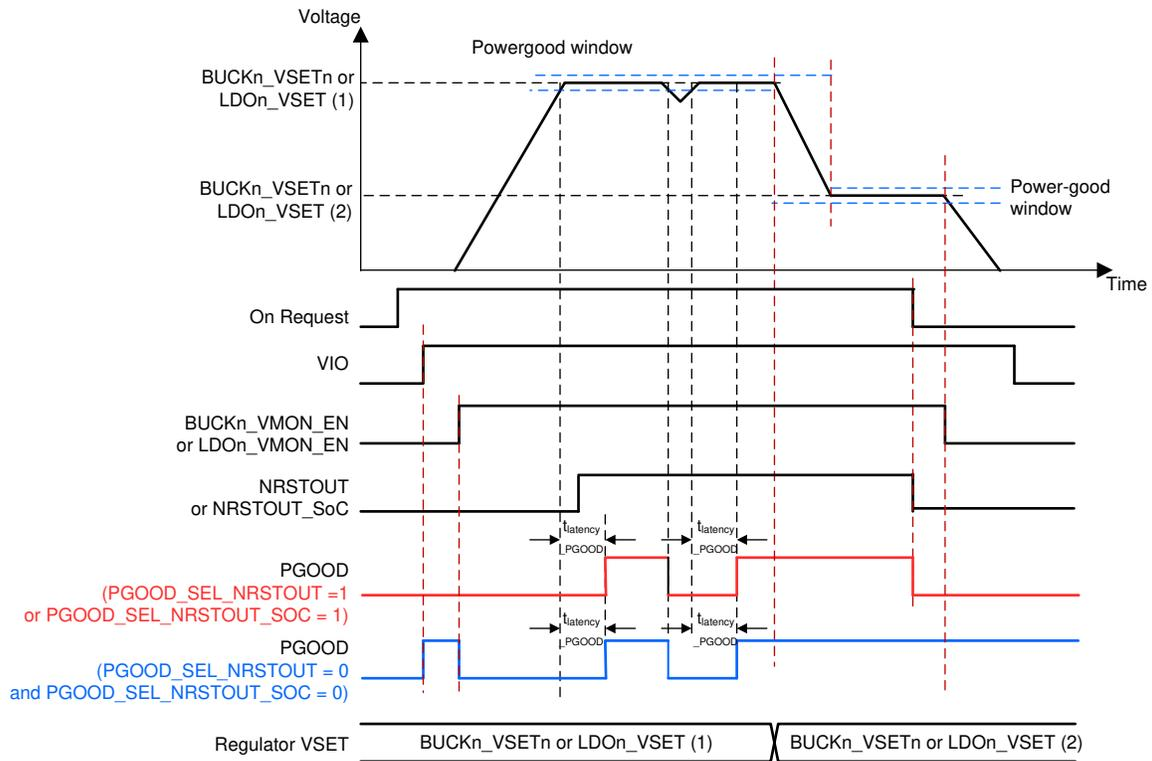
图 8-12. PGOOD Waveforms
