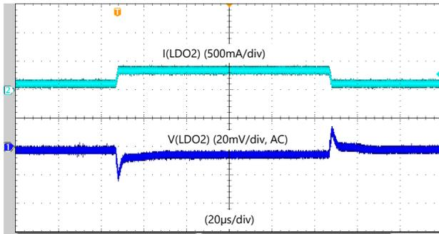
$V_{IN} = 3.3\text{ V}$        $V_{OUT} = 0.85\text{ V}$        $T_A = 25\text{ }^\circ\text{C}$
