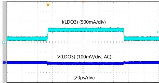
$V_{IN} = 5\text{ V}$        $V_{OUT} = 3.3\text{ V}$        $T_A = 25\text{ }^\circ\text{C}$
