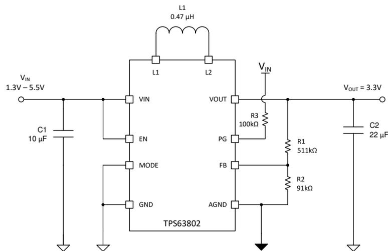
图 10-1. 3.3 V<sub>OUT</sub> Typical Application
