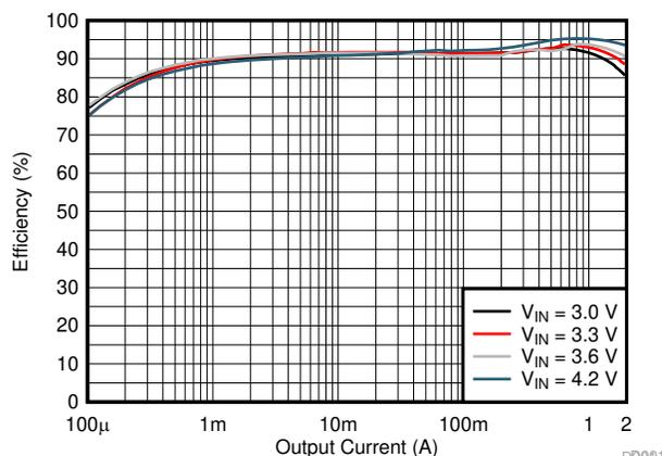
效率与输出电流间的关系 ( $V_O = 3.3V$ )
