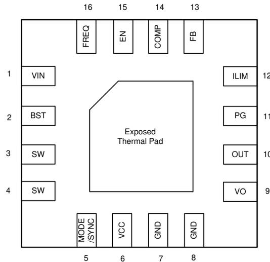
图 6-1. 16-Pin WQFN RTE Package (Transparent Top View)
