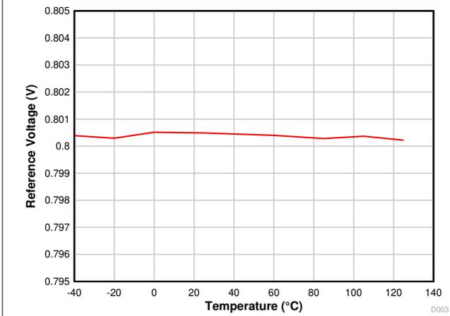
图 7-9. Reference Voltage vs Temperature
