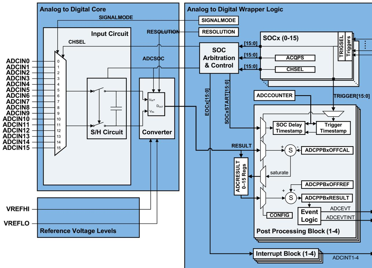
图 8-30. ADC 模块方框图
