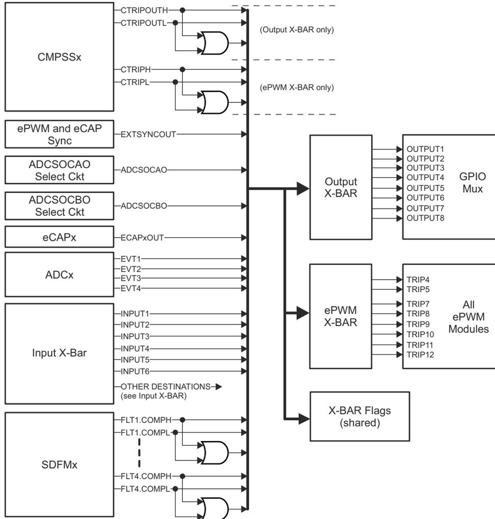
图 7-8. 输出 X-BAR 和 ePWM X-BAR
