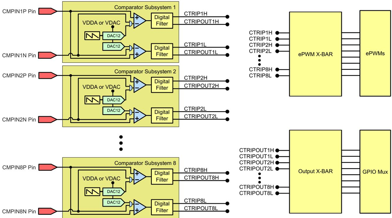
图 8-37. CMPSS 连接 ( 337 焊球 ZWT 和 176 引脚 PTP )
