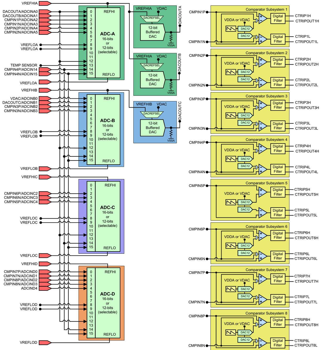
图 8-28. 模拟子系统方框图 ( 176 引脚 PTP )
