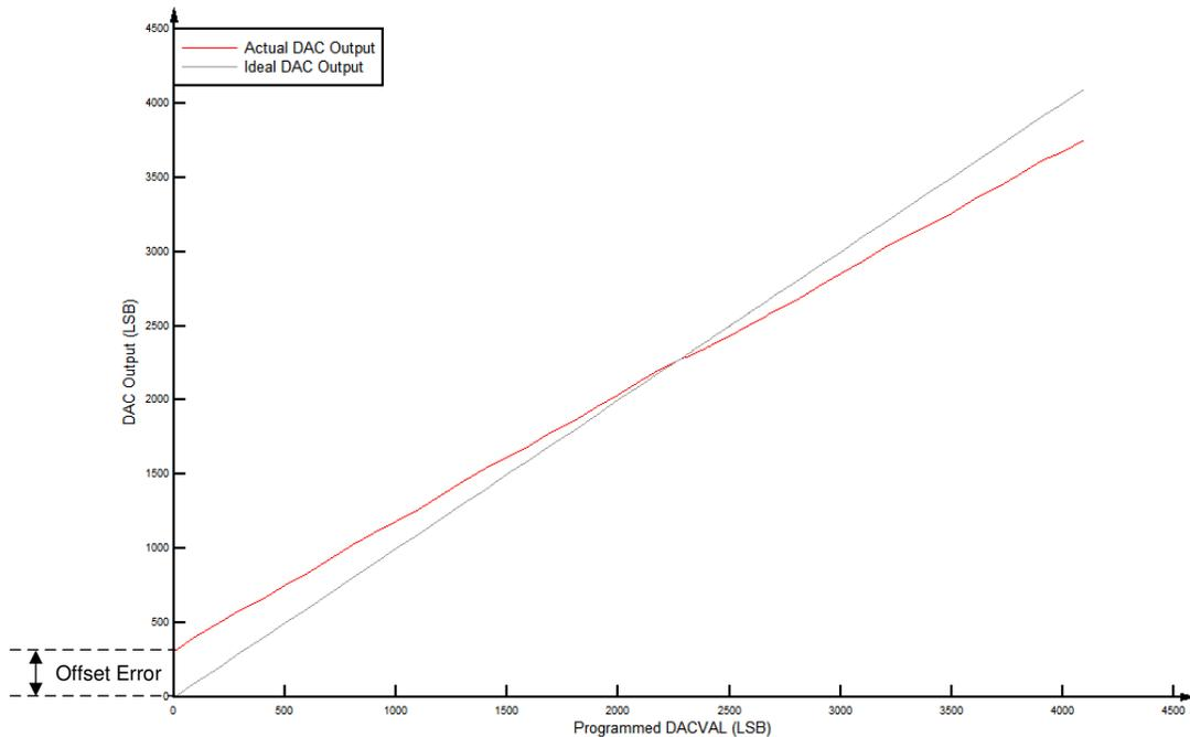
图 8-41. CMPSS DAC 静态失调电压
