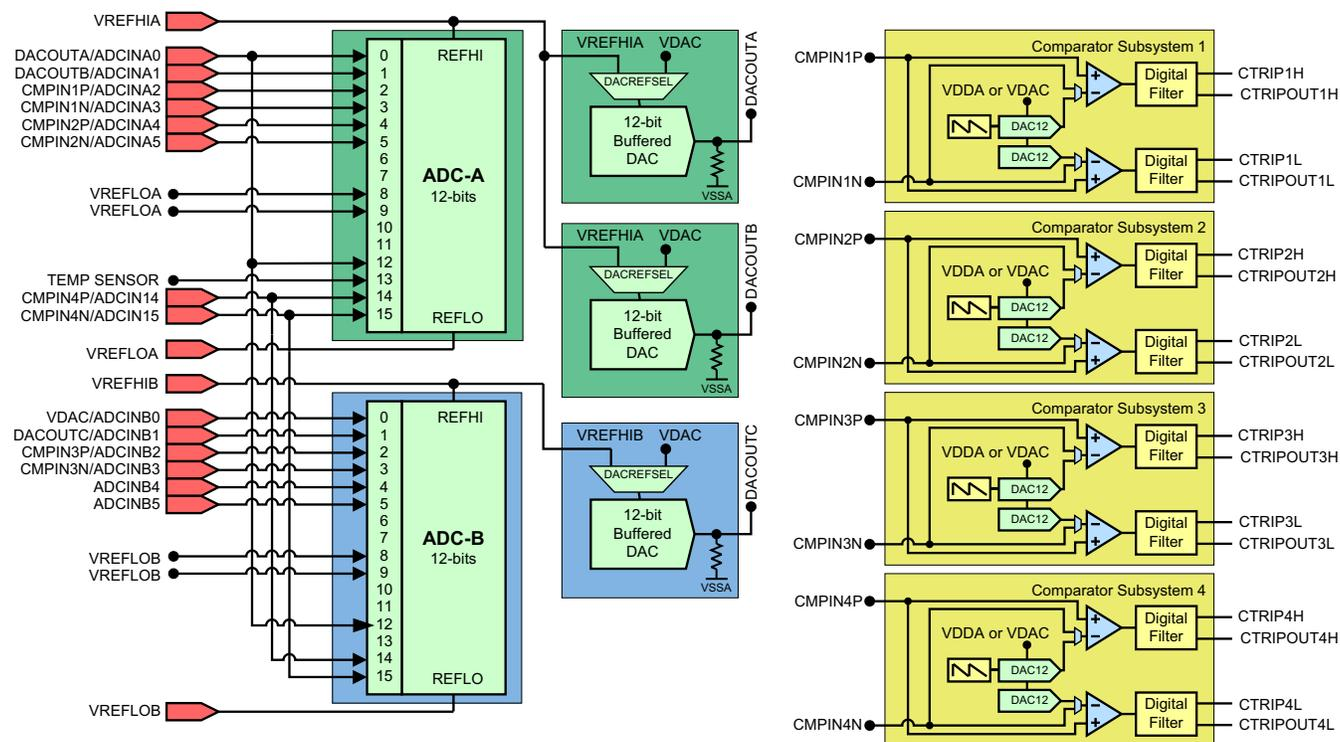
图 8-29. 模拟子系统方框图 ( 100 引脚 PZP )
