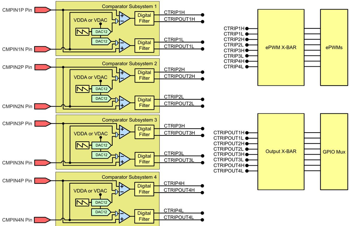
图 8-38. CMPSS 连接 ( 100 引脚 PZP )
