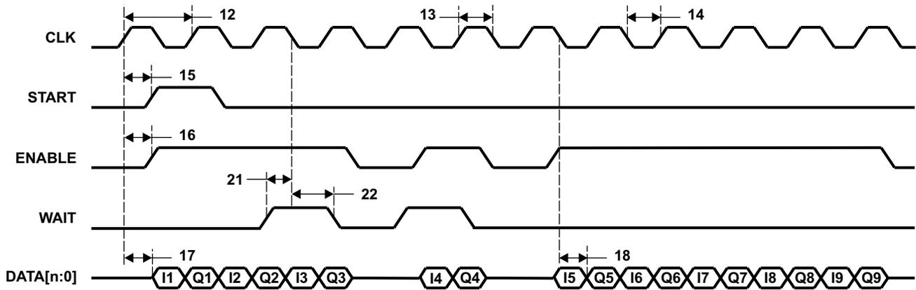
图 8-82. uPP 双倍数据速率 (DDR) 发送时序
