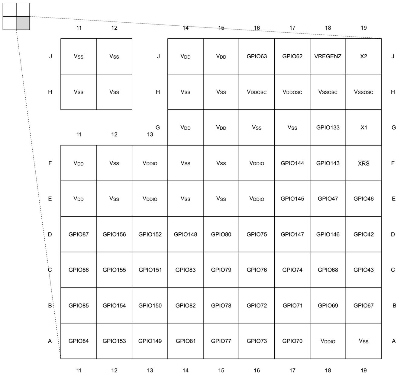
A. GPIO 终端上仅显示 GPIO 功能。有关完整的多路复用信号名称，请参阅节 7.2.1。
