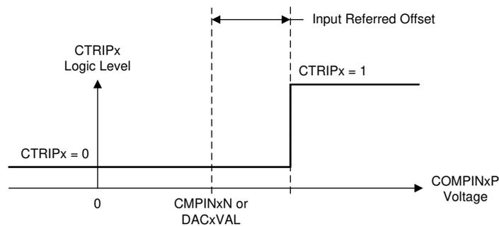
图 8-39. CMPSS 比较器输入为基准的失调电压
