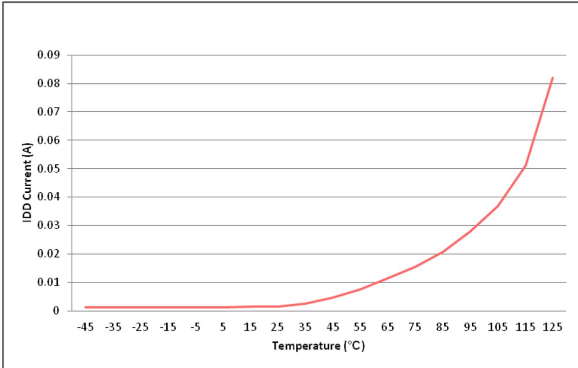
图 8-3.  $I_{DD}$  漏电流与温度间的关系
