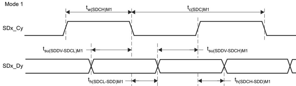
图 8-57. SDFM 时序图 - 模式 1
