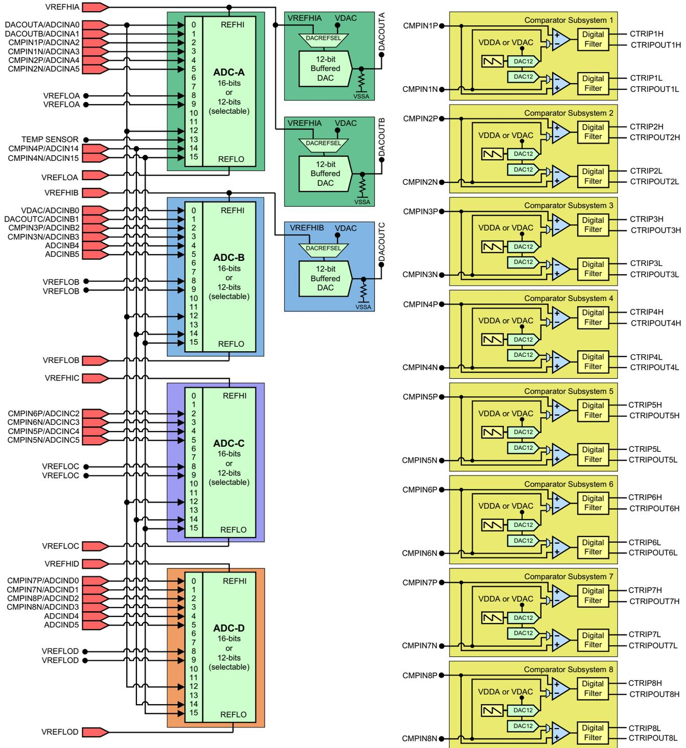
图 8-27. 模拟子系统方框图 ( 337 焊球 ZWT )
