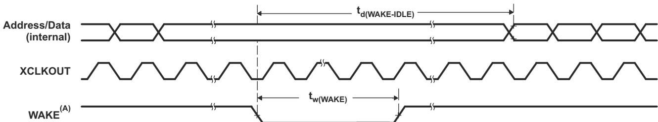
A. 唤醒可以是任一启用的中断， $\overline{WDINT}$  或  $\overline{XRS}$ 。IDLE 指令执行后，在唤醒信号生效前需要 5 个 OSCCLK 周期（最少）的延迟。
