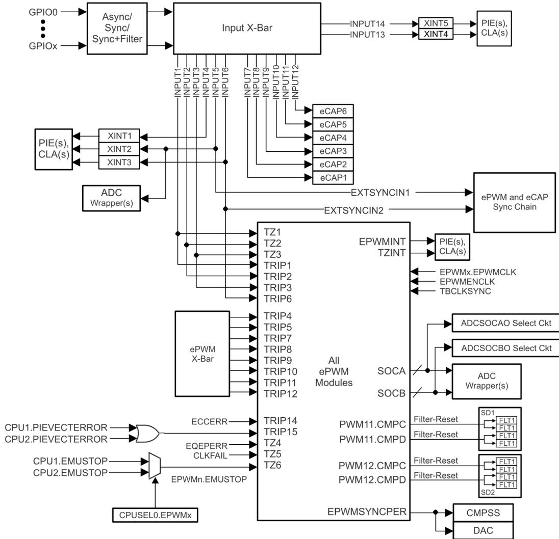
图 8-50. ePWM 跳变输入连接
