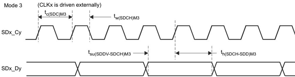
图 8-59. SDFM 时序图 - 模式 3
