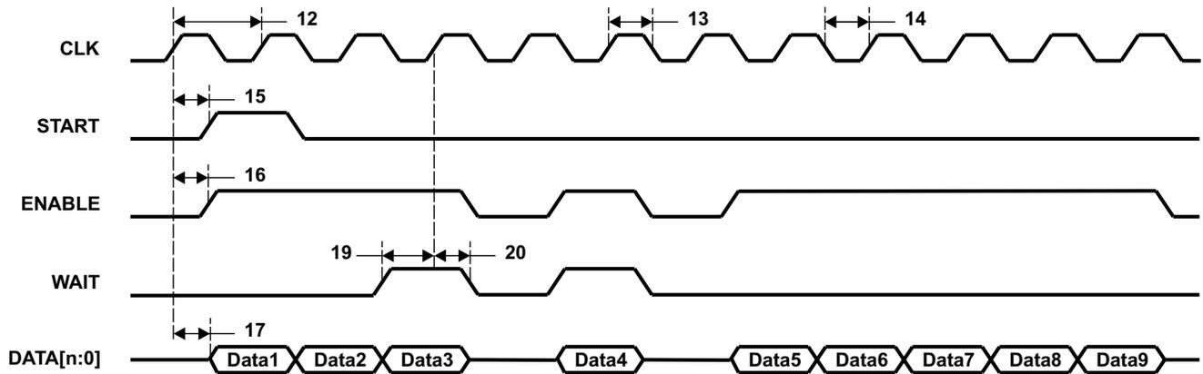
图 8-81. uPP 单倍数据速率 (SDR) 发送时序
