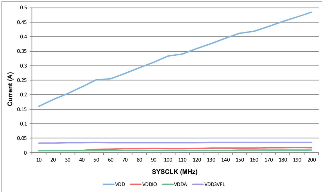
图 8-1. 工作电流与频率间的关系
