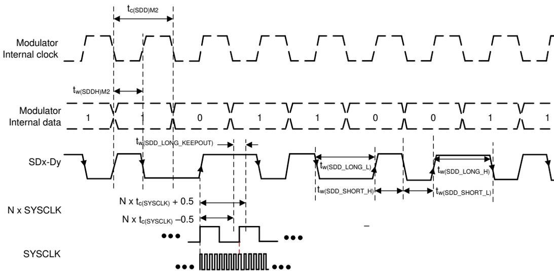
图 8-58. SDFM 时序图 - 模式 2
