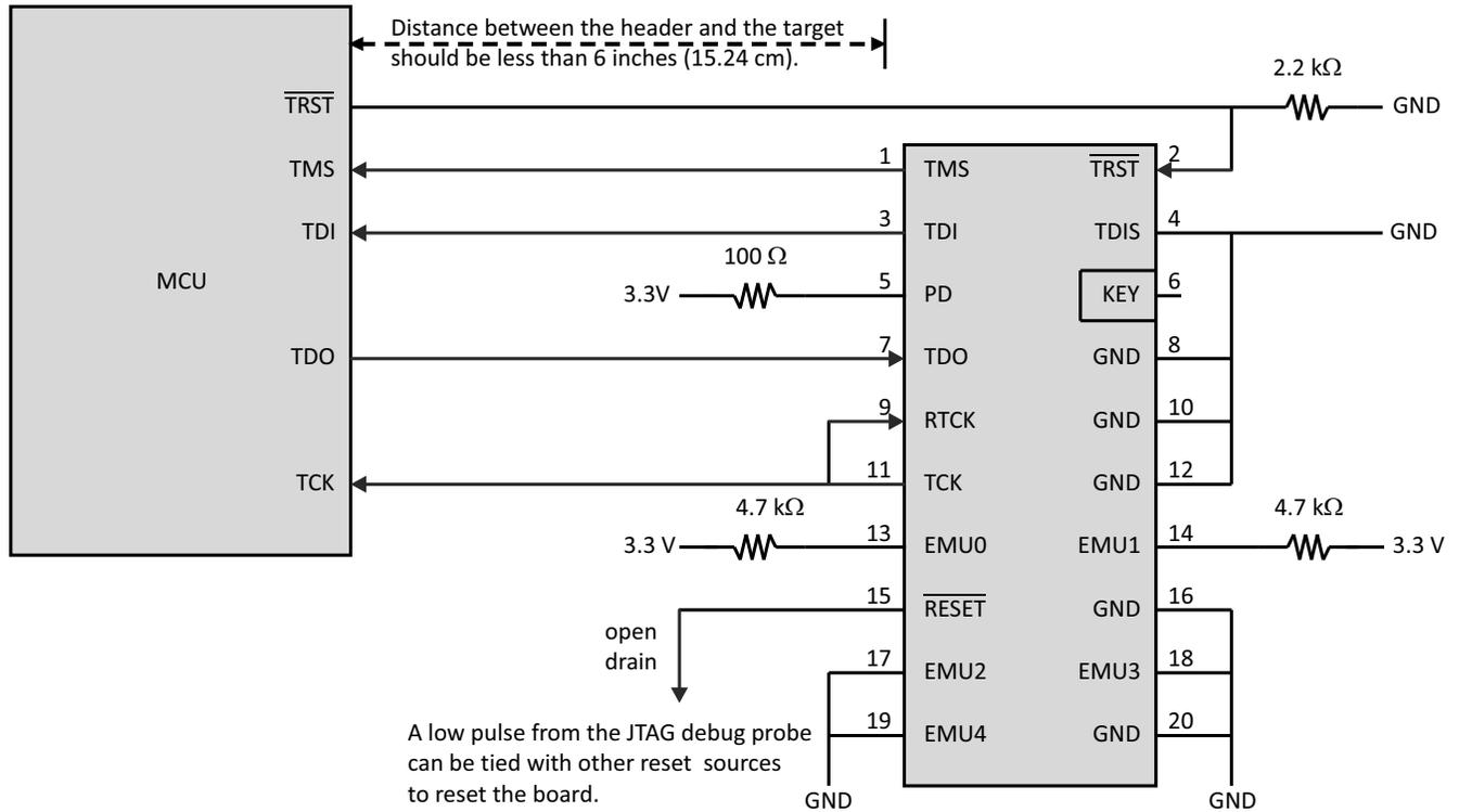
图 8-10. 连接到 20 引脚 JTAG 接头
