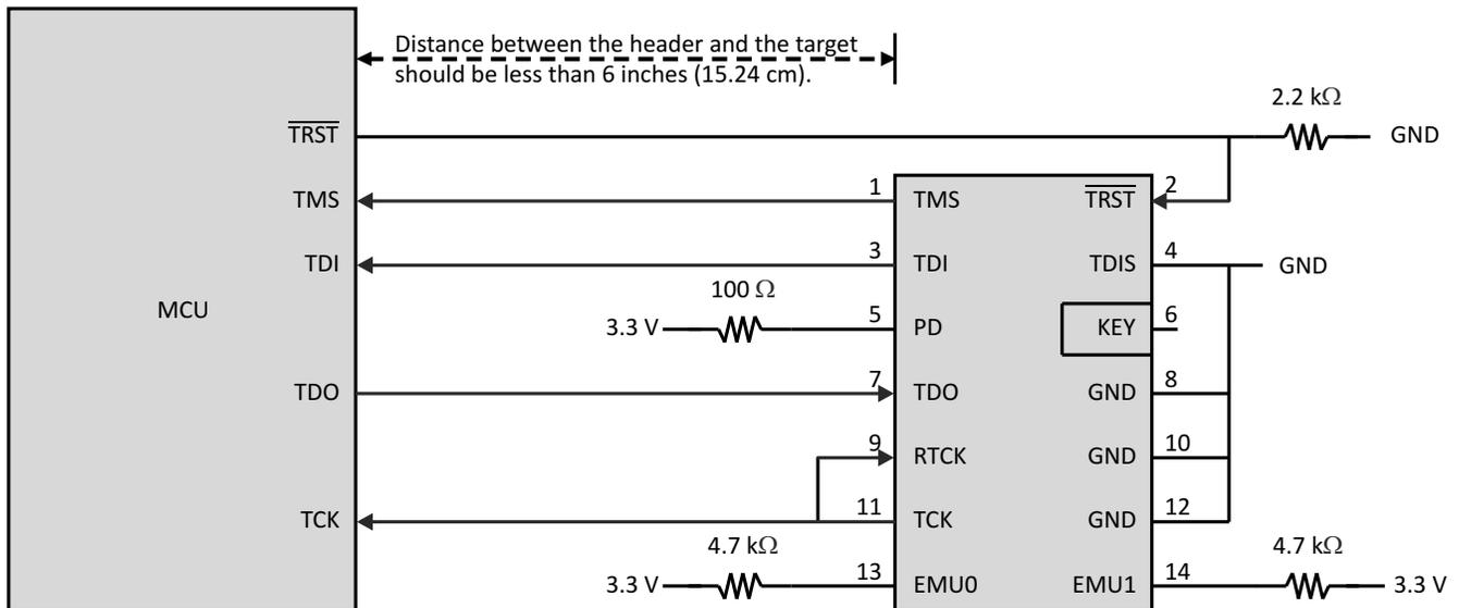
图 8-9. 连接到 14 引脚 JTAG 接头
