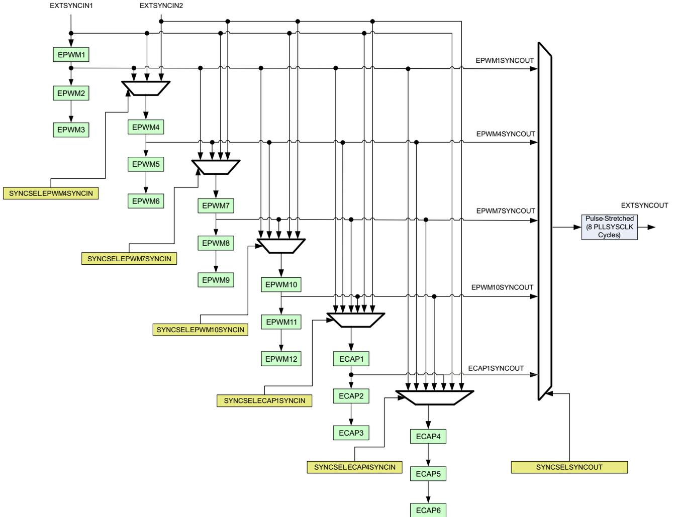
图 8-51. 同步链架构
