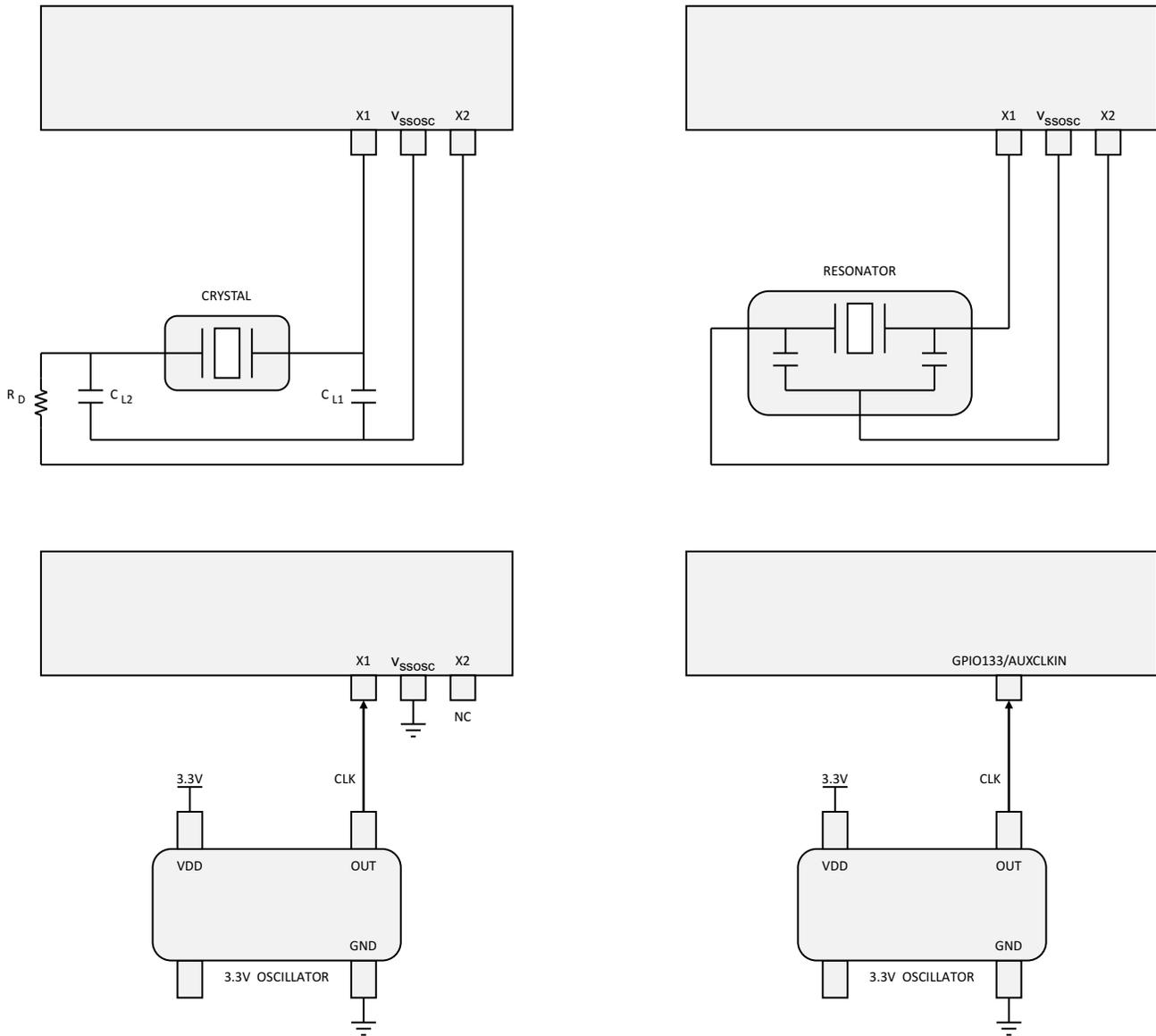
图 8-8. 将输入时钟连接到 2837xD 器件
