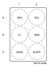
图 5-2. YBG 封装 6 引脚 DSBGA 顶视图
