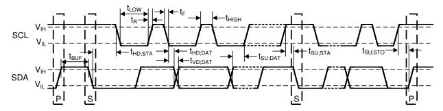
图 6-1. 两线制时序图
