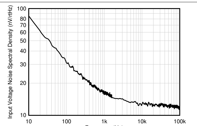
图 7-30. 输入电压噪声频谱密度
