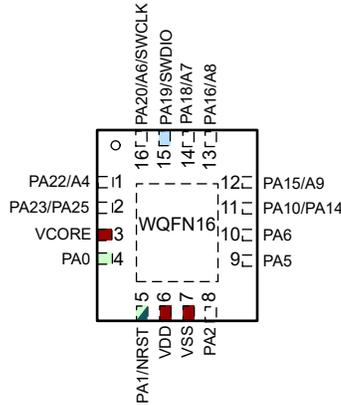
图 6-6. 16 引脚 RTR (WQFN) (顶视图)
