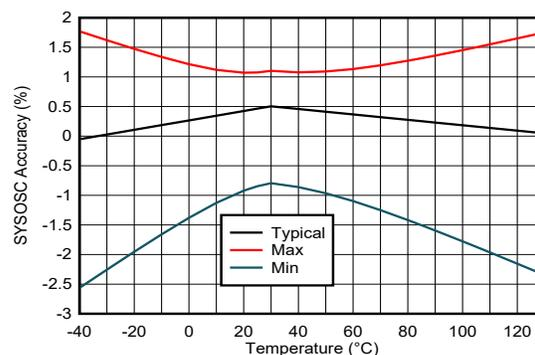
图 7-3. FCL 关闭时的 SYSOSC 精度 (32MHz)
