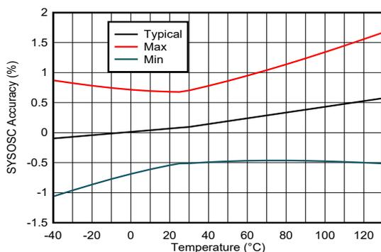
图 7-2. FCL 启用时的 SYSOSC 精度 (32MHz)
