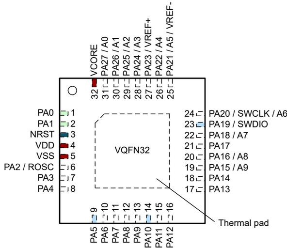
图 6-2. 32 引脚 RHB (VQFN) (顶视图)
