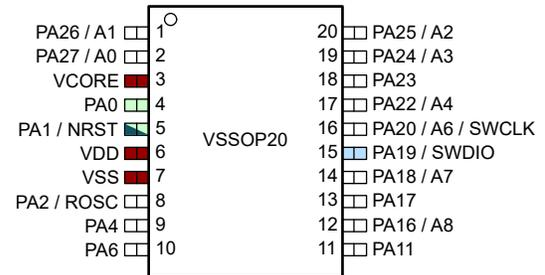
图 6-5. 20 引脚 DGS20 (VSSOP) (顶视图)
