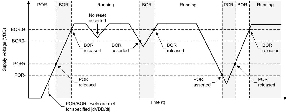
图 7-1. 下电上电 POR 和 BOR 条件
