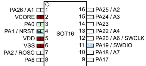
图 6-7. 16 引脚 DYY (SOT) (顶视图)
