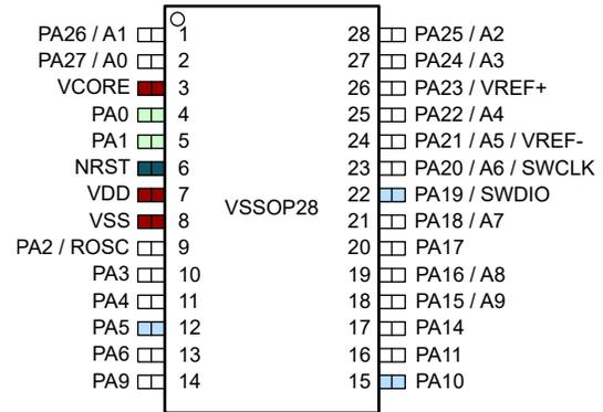
图 6-3. 28 引脚 DGS28 (VSSOP) (顶视图)
