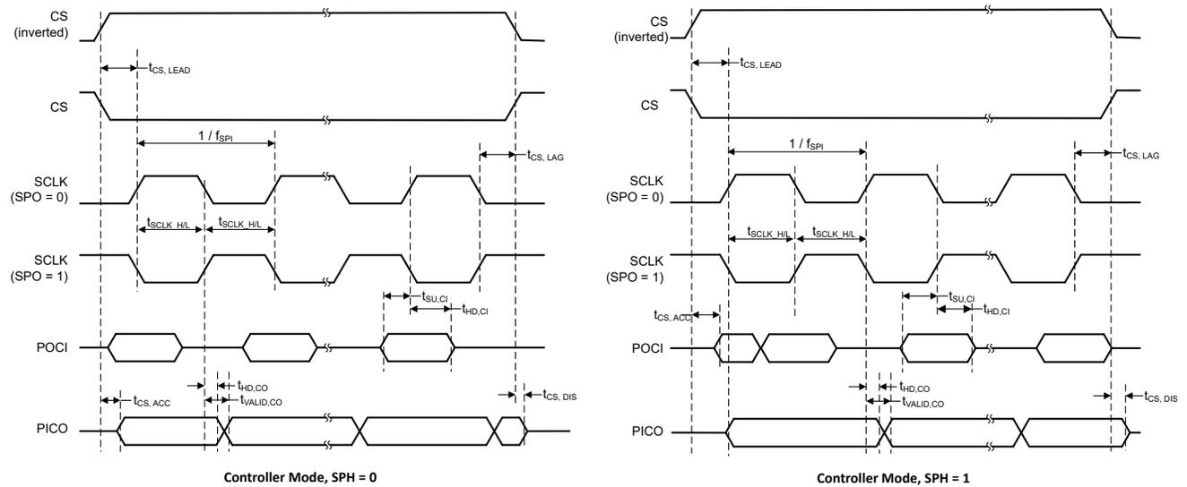
图 7-6. SPI 时序图 - 控制器模式
