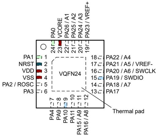
图 6-4. 24 引脚 RGE (VQFN) (顶视图)
