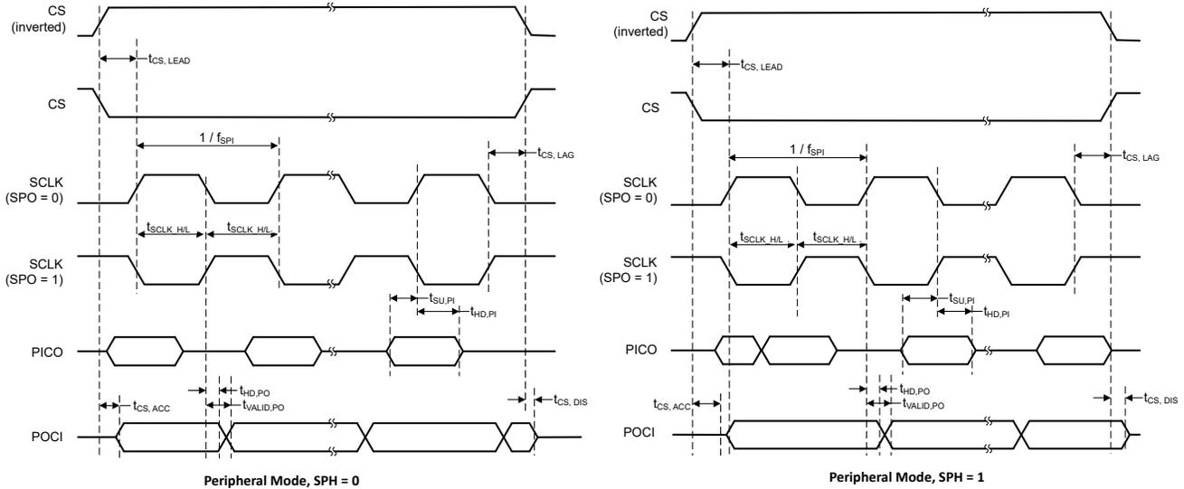
图 7-7. SPI 时序图 - 外设模式
