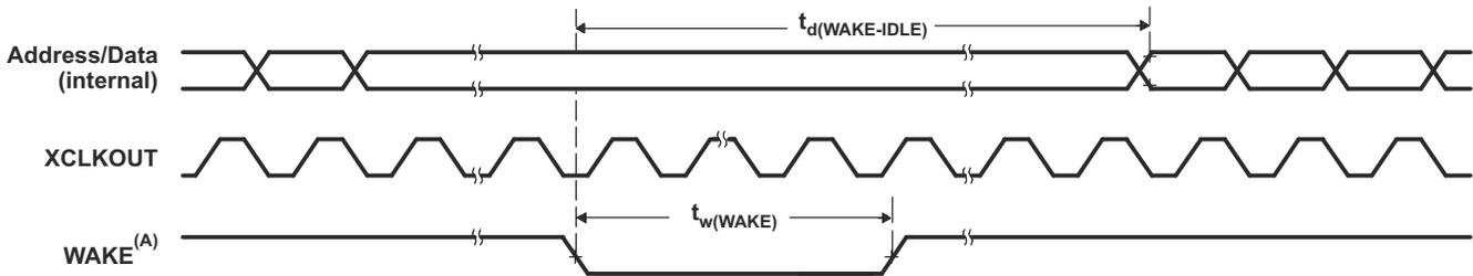
A. WAKE 可以是任何启用的中断、 $\overline{WDINT}$  或 XRSn。IDLE 指令执行后，在唤醒信号生效前需要 5 个 OSCCLK 周期（最少）的延迟。
