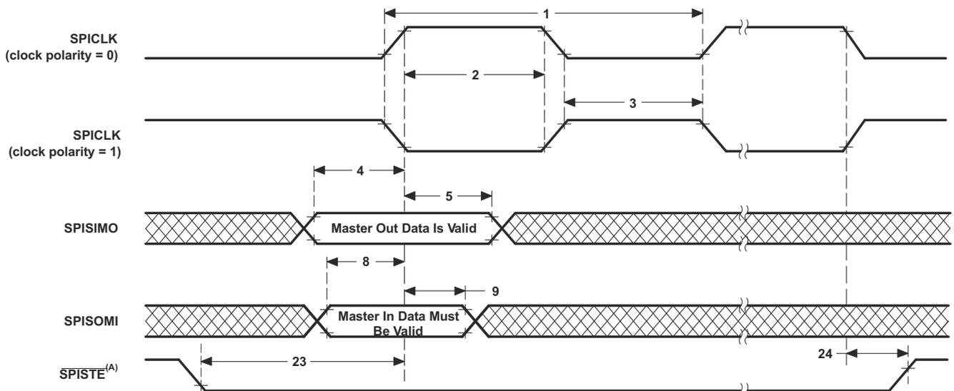
A. 除了在 FIFO 和非 FIFO 模式下的背对背传输字之间的情况外，在字的尾端， $\overline{\text{SPISTE}}$  将变为停止状态。
