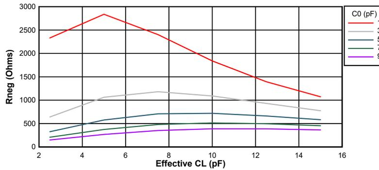
图 7-22. 10MHz 时的负电阻变化
