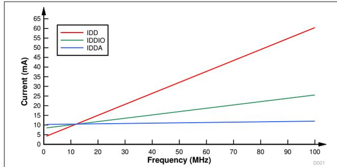
图 7-2. 电流与频率间的关系 - 外部电源
