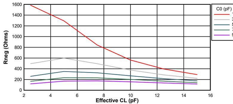
图 7-23. 20MHz 时的负电阻变化
