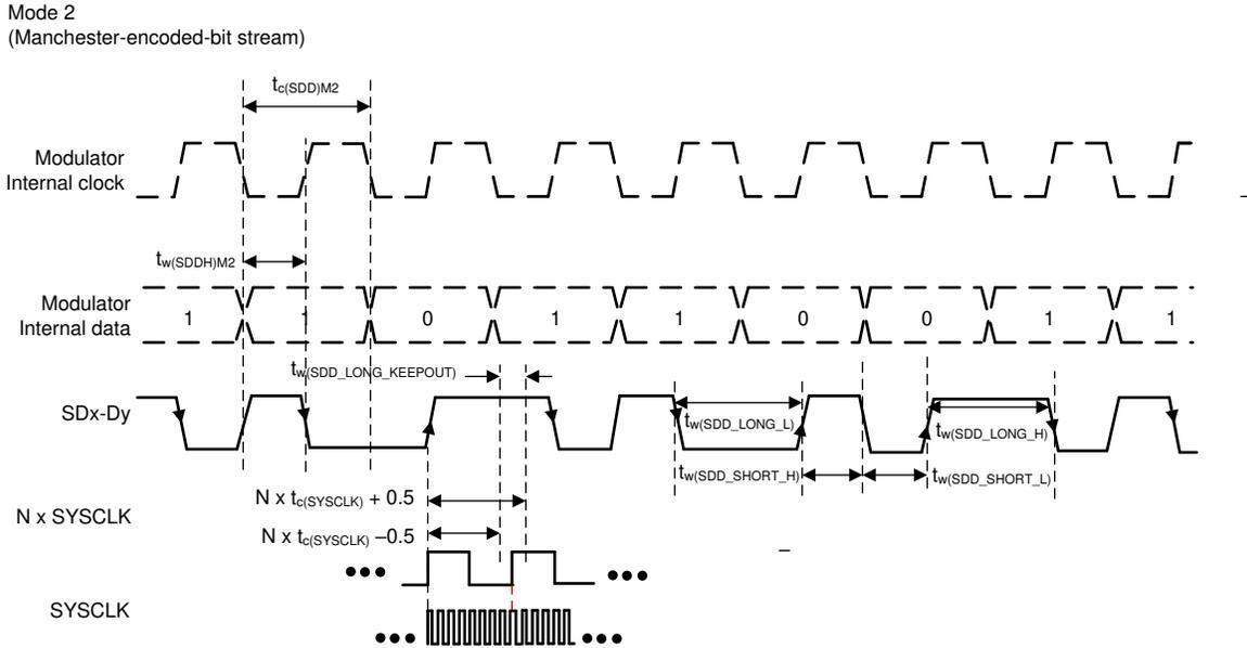
图 7-76. SDFM 时序图 - 模式 2
