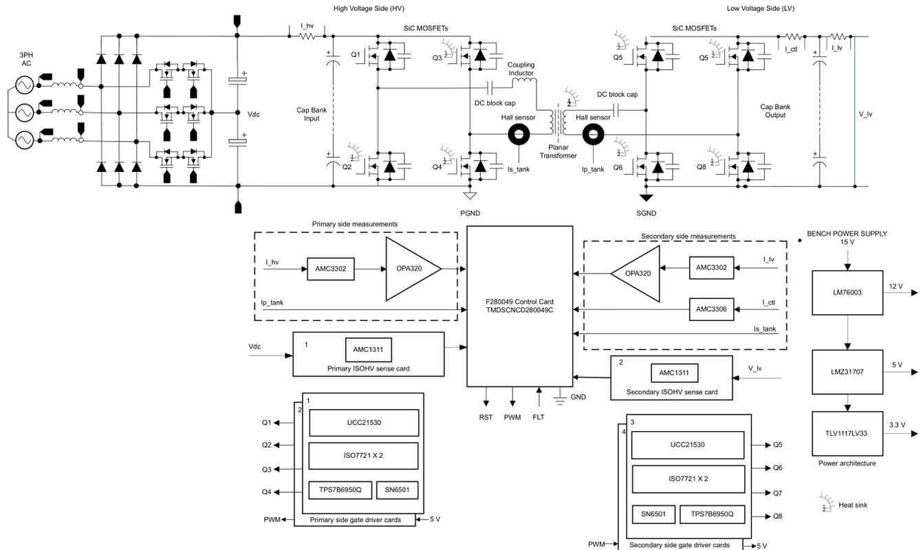
图 9-6. 双有源电桥直流/直流转换器
