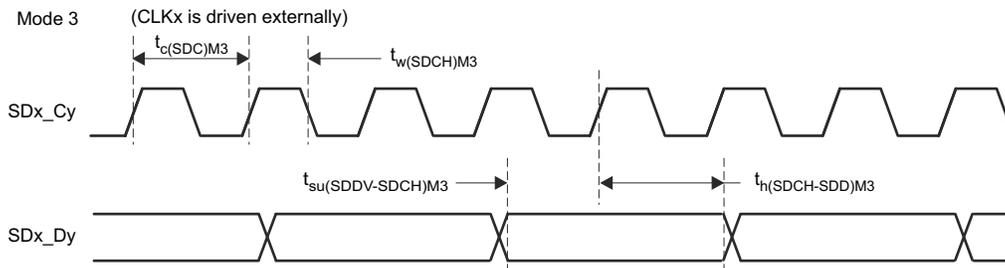
图 7-77. SDFM 时序图 - 模式 3
