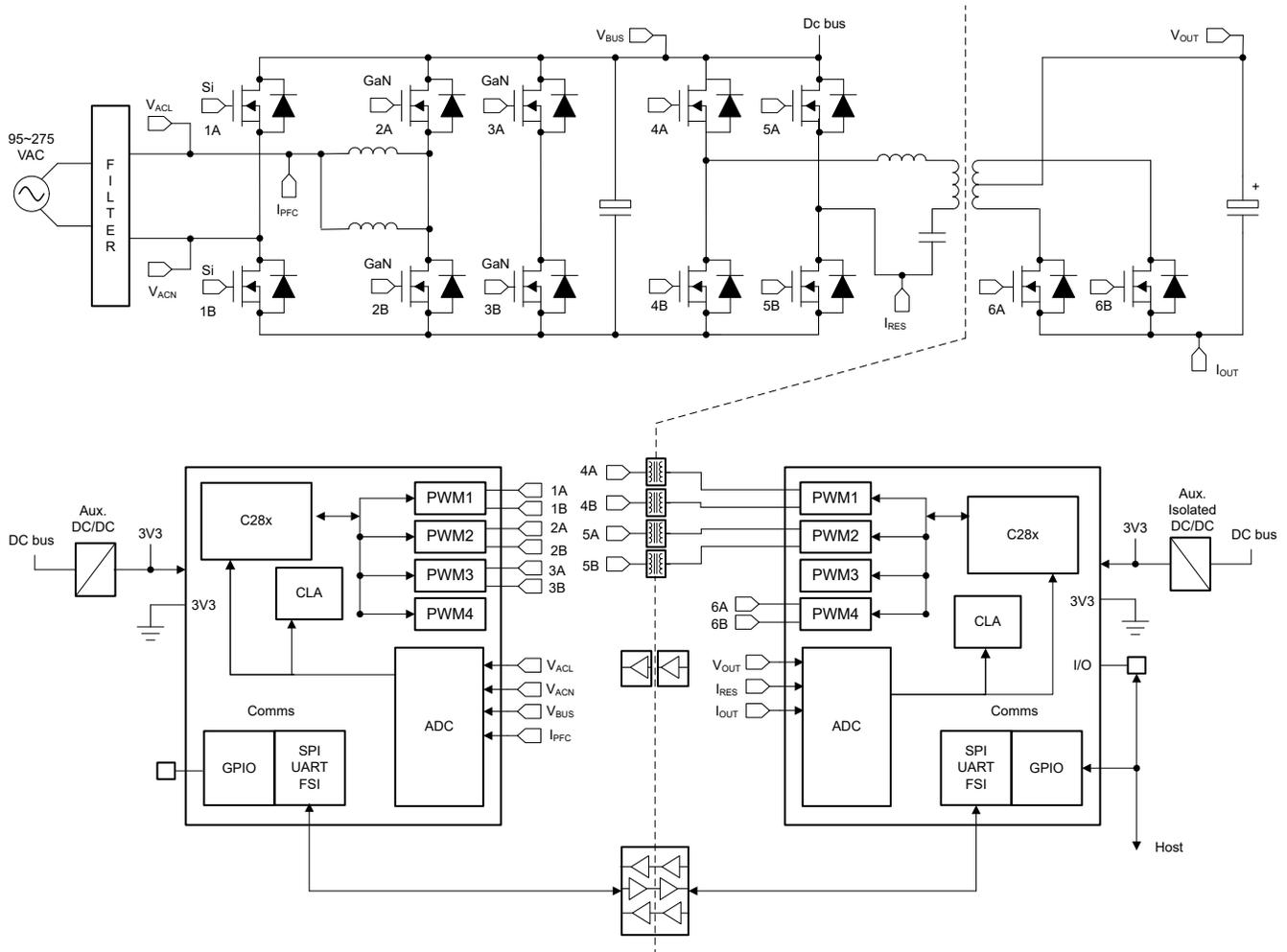
图 9-1. 典型的服务器 PSU 架构
