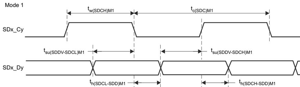
图 7-75. SDFM 时序图 - 模式 1
