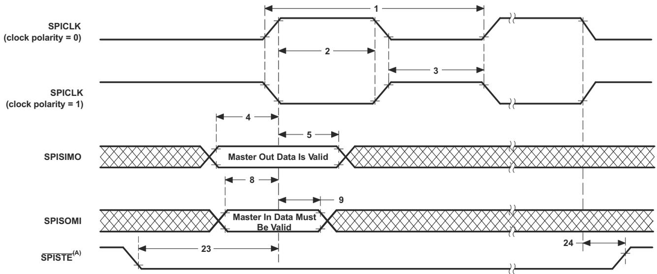
A. 除了在 FIFO 和非 FIFO 模式下的背对背传输字之间的情况外，在字的尾端， $\overline{\text{SPISTE}}$  将变为停止状态。
