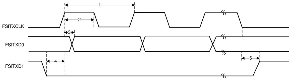
图 7-99. FSITX SPI 信令模式时序
