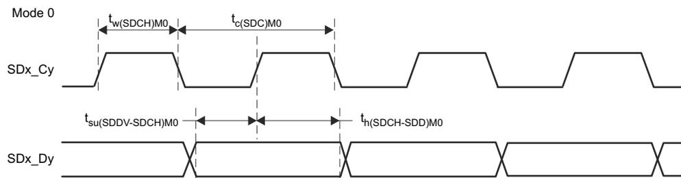
图 7-74. SDFM 时序图 - 模式 0
