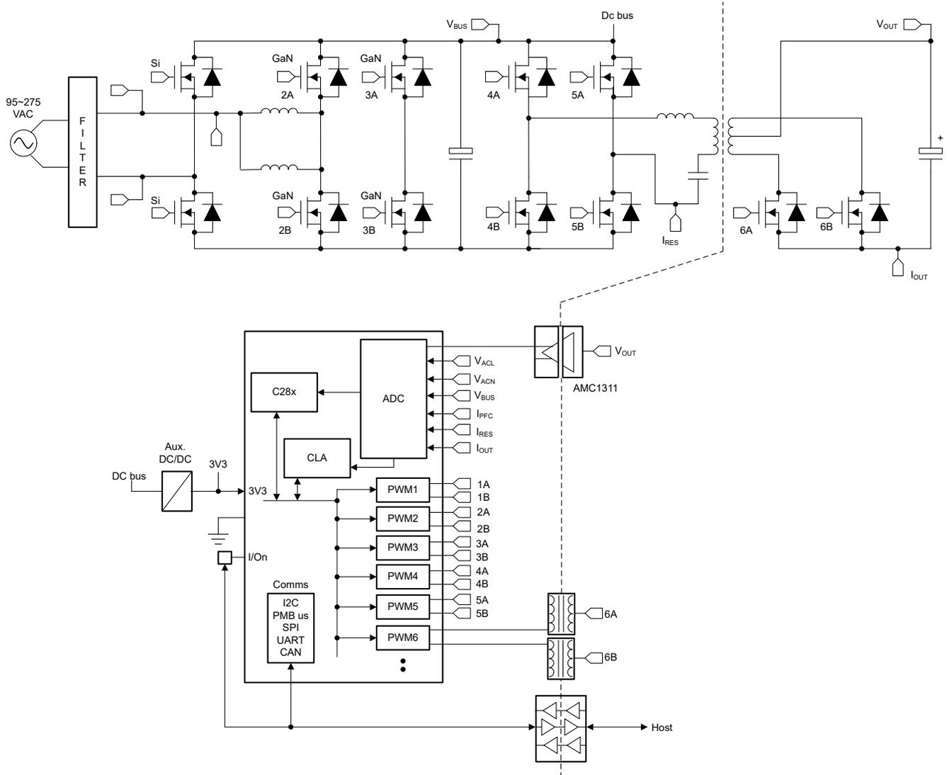
图 9-2. 典型的电信 PSU 架构
