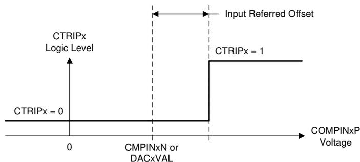
图 7-58. CMPSS 比较器以输入为基准的偏移量
