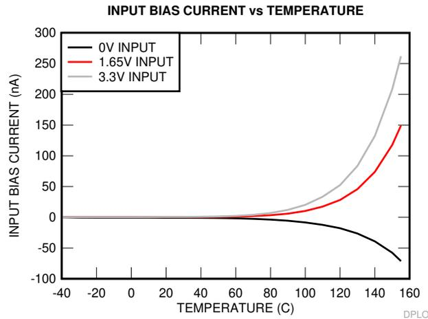
图 7-46. 输入偏置电流与温度间的关系
