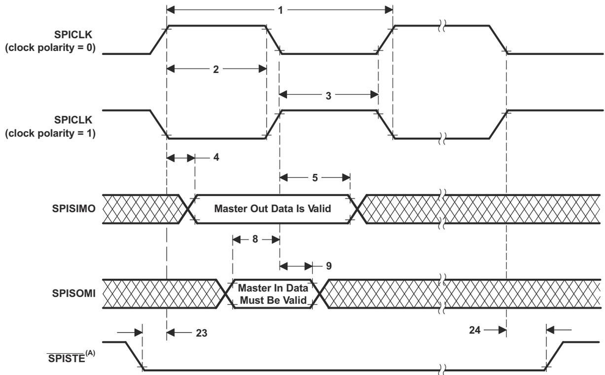
A. 除了在 FIFO 和非 FIFO 模式下的背对背传输字之间的情况外，在字的尾端， $\overline{\text{SPISTE}}$  将变为停止状态。
