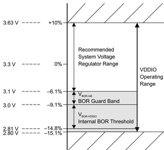
图 7-11. 电源电压
