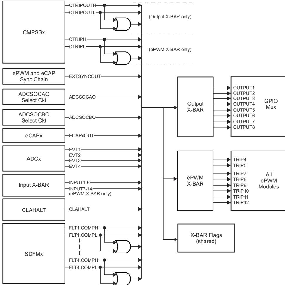
图 6-6. 输出 X-BAR 和 ePWM X-BAR 源
