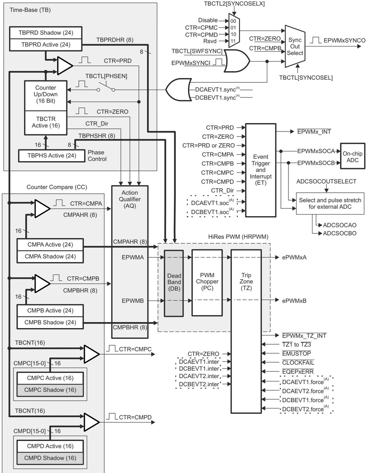
A. 这些事件由 ePWM 数字比较 (DC) 子模块根据 TRIPIN 输入电平生成。
