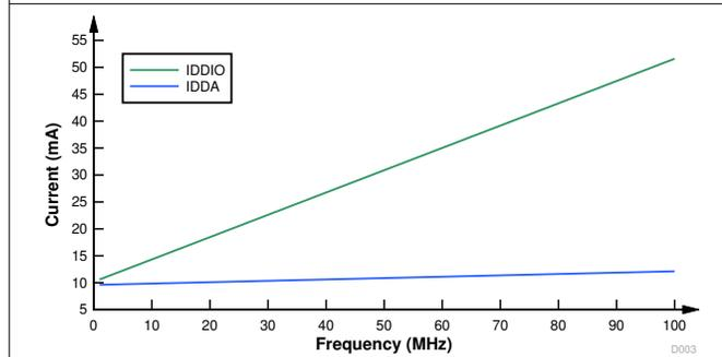
图 7-4. 电流与频率间的关系 - 直流/直流
