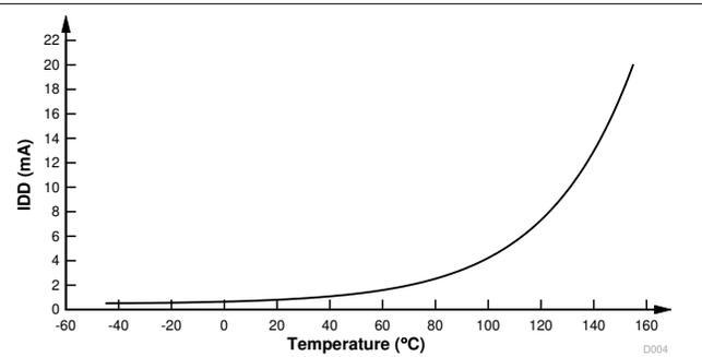
图 7-5. Halt 电流与温度间的关系 (°C)
