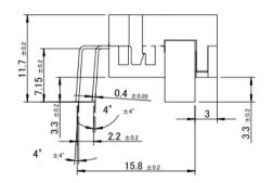
端子材質: Cu 端子めっき材: Sn 100%
