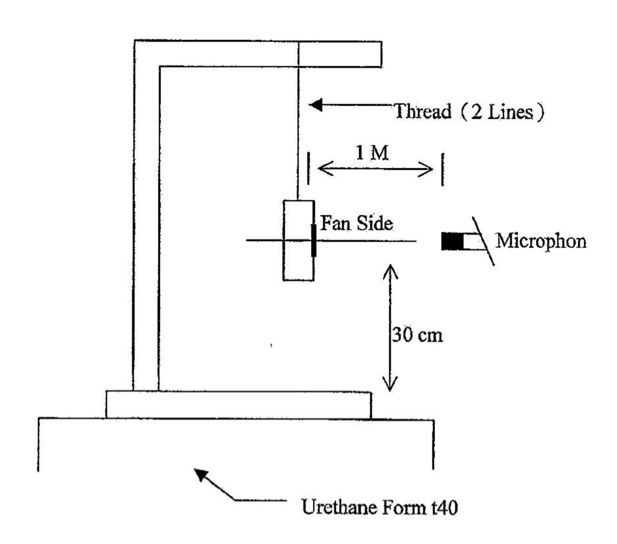
1 METER FROM MICROPHONE TO FAN INTAKE
