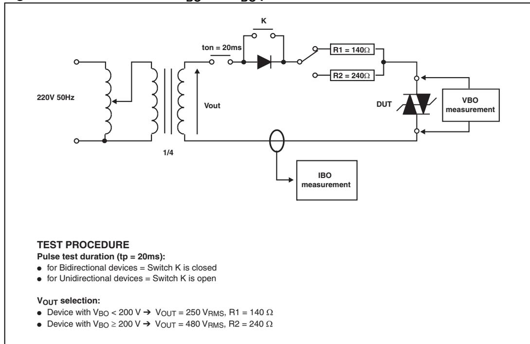
Figure 18. Test circuit 3 for dynamic  $I_H$  parameter
