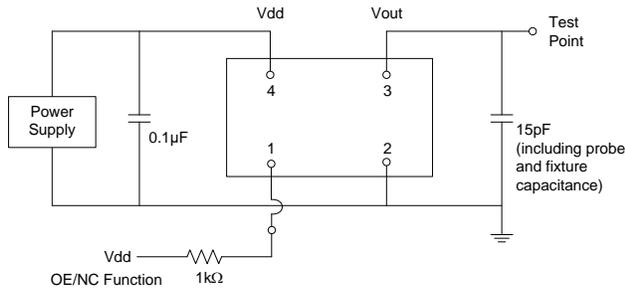
**Figure 2. Test Circuit**<sup>[8]</sup>
