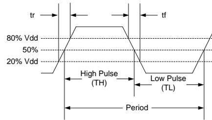
**Figure 3. Waveform**<sup>[8]</sup>
