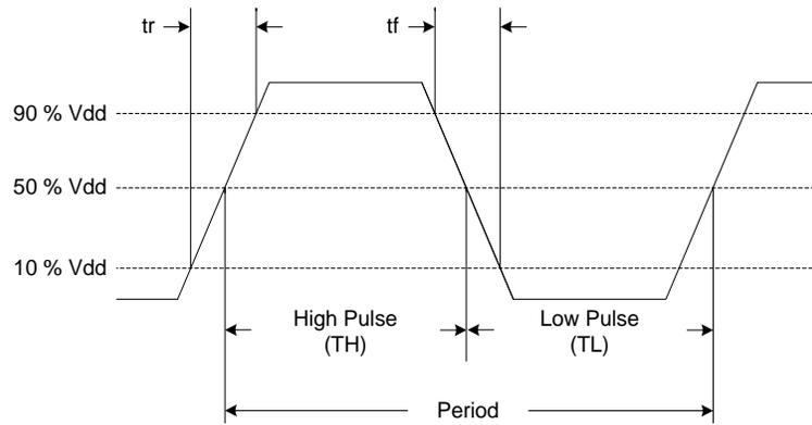
Figure 15. LVC MOS Waveform Diagram<sup>[12]</sup>
