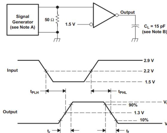
A、输入脉冲产生器特点：脉冲重复速率  $PRR \leq 500\text{kHz}$ ，50% 占空比， $t_r < 6\text{ns}$ ， $t_f < 6\text{ns}$ ， $Z_o = 50\Omega$
