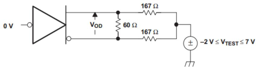
**图 3 驱动器 VOD 测试电路**
