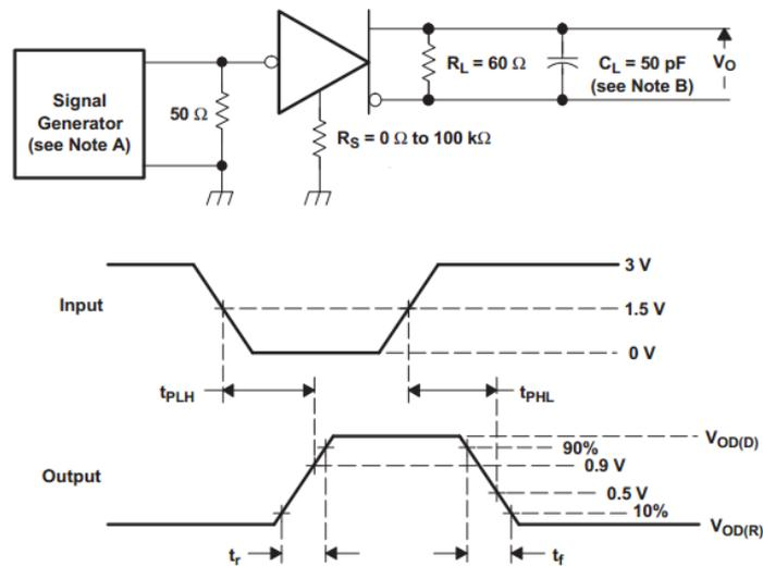
A、输入脉冲产生器特点：脉冲重复速率  $PRR \leq 500\text{KHz}$ ，50% 占空比， $t_r < 6\text{ns}$ ， $t_f < 6\text{ns}$ ， $Z_o = 50\Omega$
