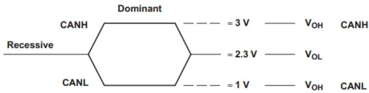
**图 2 总线逻辑电压定义**
