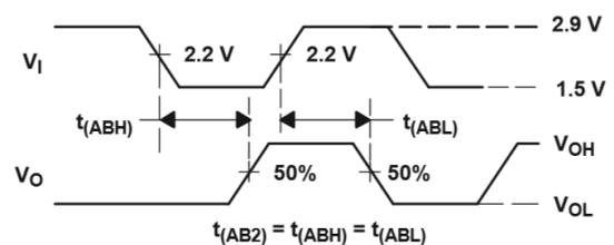
A、输入脉冲产生器特点：脉冲重复速率  $PRR = 125\text{KHz}$ ，50% 占空比， $t_r < 6\text{ns}$ ， $t_f < 6\text{ns}$
