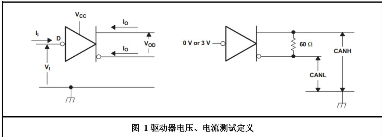
图 1 驱动器电压、电流测试定义
