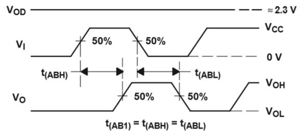
A、输入脉冲产生器特点：脉冲重复速率  $PRR = 125\text{KHz}$ ，50% 占空比， $t_r < 6\text{ns}$ ， $t_f < 6\text{ns}$
