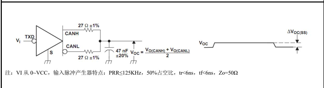
**图 7 共模输出电压测试与波形**
