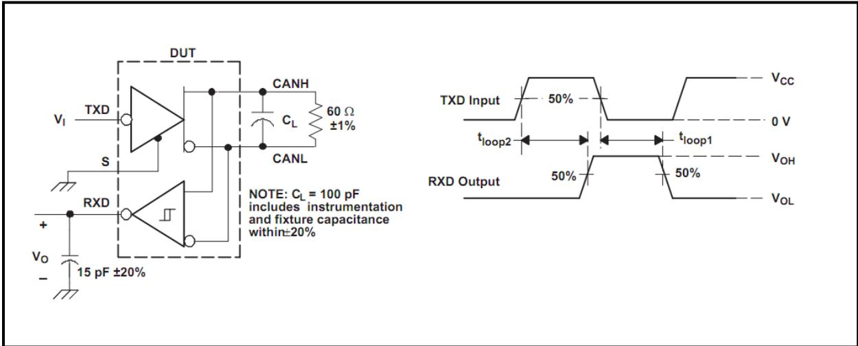
**图 8  $t_{loop}$  测试电路与波形**
