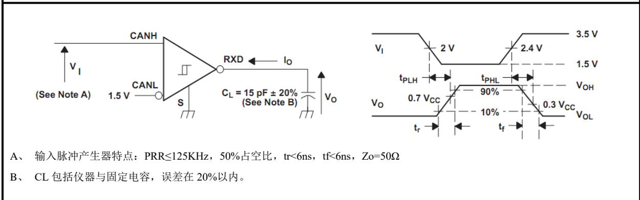
**图 6 接收器测试电路与电压波形**
