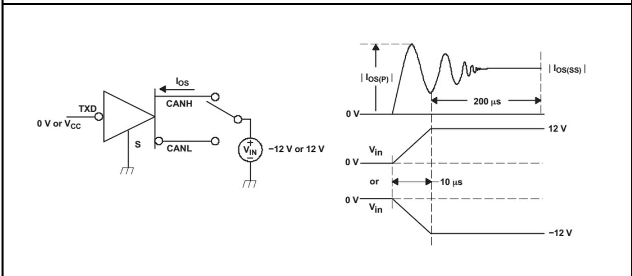
**图 10 驱动器短路电流测试电路与波形**
