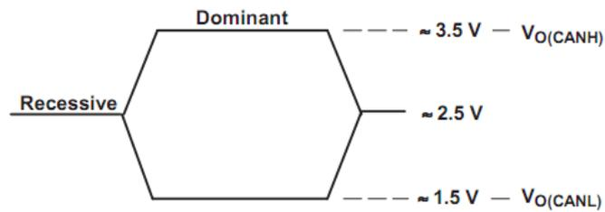
图 2 总线逻辑电压定义
