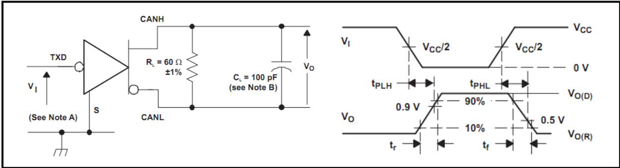
**图 4 驱动器测试电路与电压波形**
