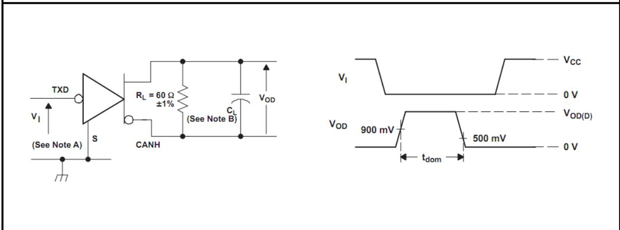
**图 9 显性超时测试电路与波形**
