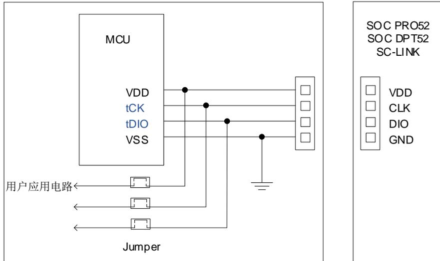
ICP 模式 Flash Writer 编程连接示意图
