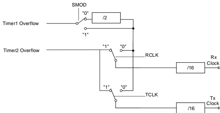
方式 1 和方式 3 波特率发生器原理
