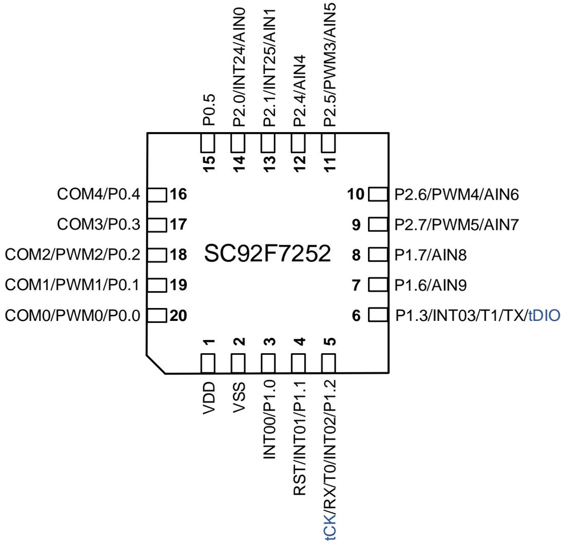
SC92F7252 管脚配置图 (QFN20)
