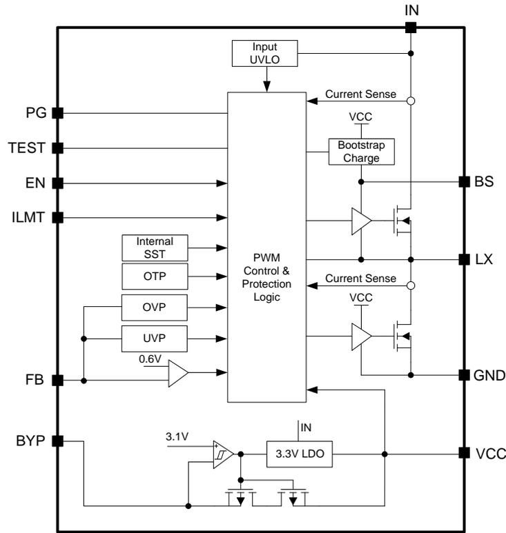
**Figure3. Block Diagram**
