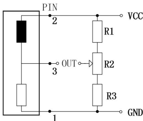
传感器主要由催化元件（黑元件）和补偿元件（白元件）组成，黑、白两个元件被安装到电桥中，通过可变电阻可调整电桥输出稳定的基准信号。当环境中存在甲烷气体时，在催化元件表面会发生燃烧，元件表面温度上升，导致元件电阻增加，电桥失衡，通过电路采集电桥的输出电压。
