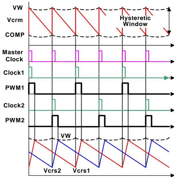
FIGURE 6. R<sup>3</sup>™ MODULATOR OPERATION PRINCIPLES IN STEADY STATE
