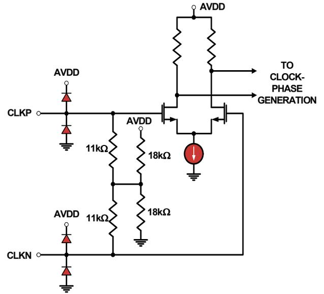
FIGURE 44. CLOCK INPUTS
