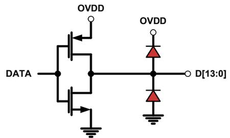
FIGURE 48. CMOS OUTPUTS
