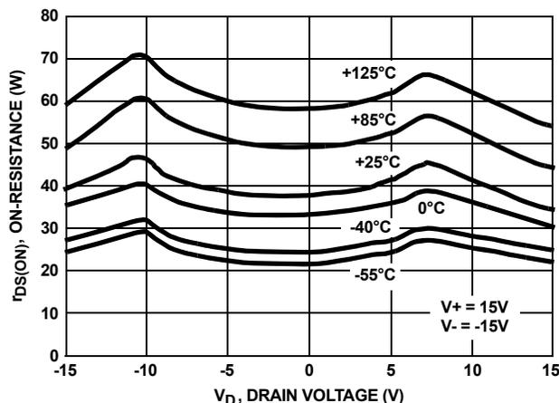
FIGURE 2. ±15V DUAL SUPPLY r<sub>ON</sub> CURVES AT VARIOUS TEMPERATURES
