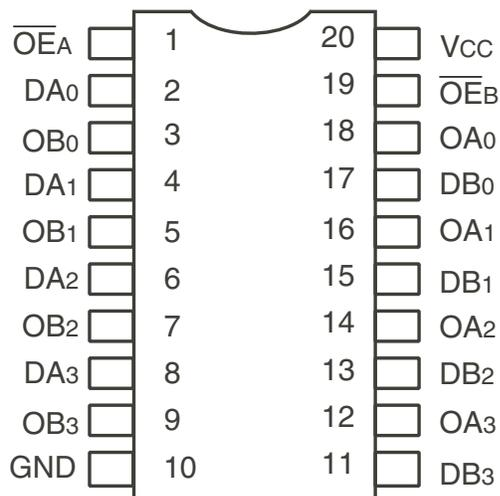
CERDIP/ SOIC/ SSOP/ QSOP/ TSSOP
