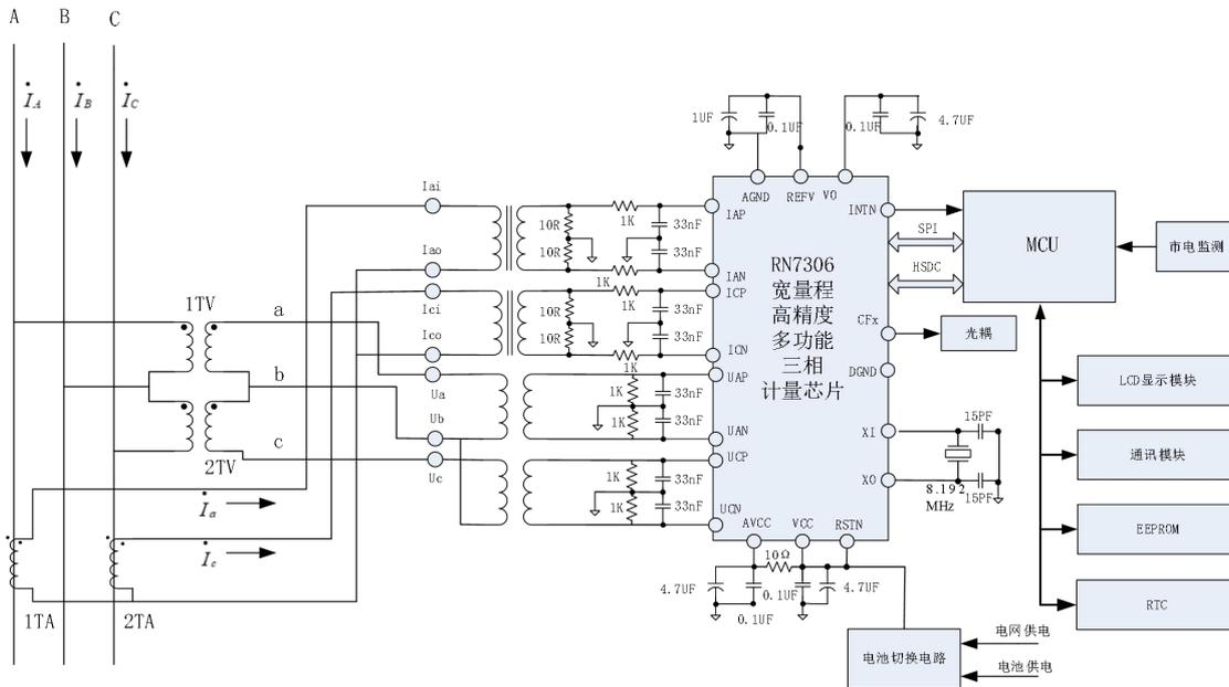
图 4-6 RN7306 应用于三相三线表时典型应用电路示意图
