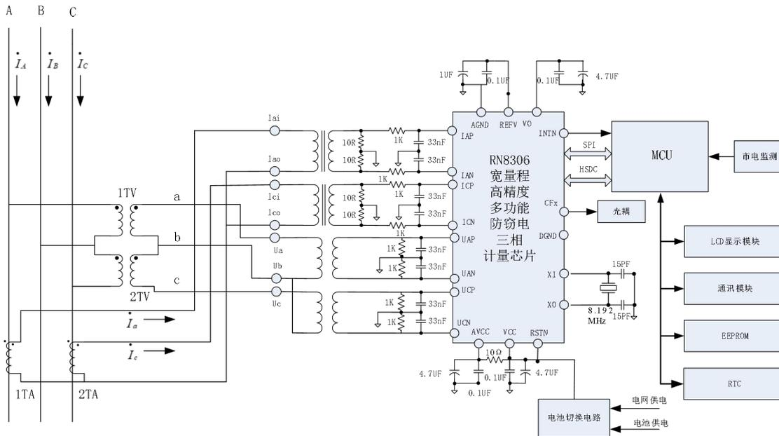
图 4-4 RN8306 应用于三相三线表时典型应用电路示意图
