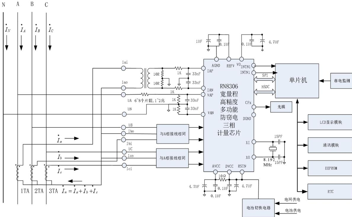
图 4-3 RN8306 应用于三相四线表时典型应用电路示意图
