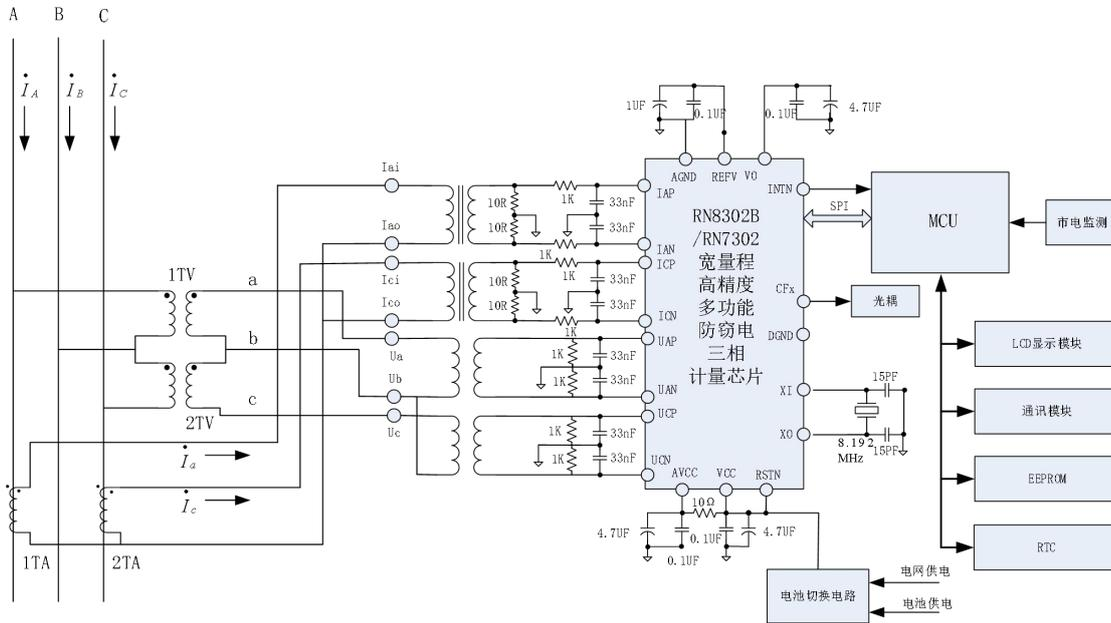
图 4-2 RN8302B/RN7302 应用于三相三线表上时典型应用电路示意图
