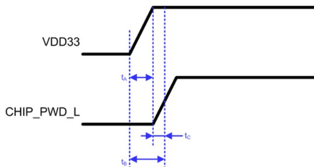
Figure 3-1 Power-On-Reset Timing
