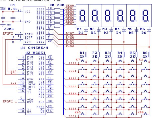
CH450 具有 48 键的键盘扫描功能,如果应用中只需要很少的按键,那么可以在 8×6 矩阵中任意 去掉不用的按键。为了防止键被按下后在 SEG 信号线与 DIG 信号线之间形成短路而影响显示,一般应该在 CH450 的 DIG2 $\sim$ DIG7 引脚与键盘矩阵之间串接限流电阻 R1–R6,其阻值可以从 1K  $\Omega$  至 10K  $\Omega$  。 当使用键盘功能时,CH450 的 INT#引脚可以连接到单片机的中断输入引脚,如果连接到普通 I/0 引脚,那么应该使用查询方式确定 CH450 是否检测到有效按键。
