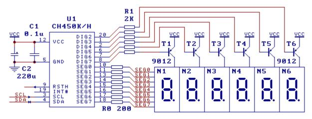
在为 DIG2 $\sim$ DIG7 字引脚增加反相器后,CH450 可以驱动共阳数码管。图中是由 6 只 PNP 三极管 T1 $\sim$ T6(型号为 9012 或 8550 等)和 6 只电阻 R1(阻值 300  $\Omega$   $\sim$ 3K  $\Omega$ )构成 6 组反相器,分别驱动 6 只共阳数码管的公共端阳极。由于该共阳接法中 CH450 的 SEG 段引脚是反相驱动,所以加载字数据命令中的字数据应该按位取反,数据位为 0 则点亮,数据位为 1 则熄灭。
