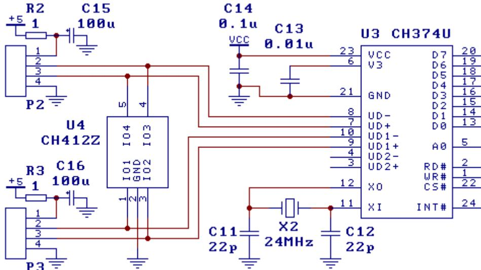
CH412Z 可以用于中低频普通信号的 ESD 保护，也可以用于全速或者低速 USB 信号的 ESD 保护。图中 CH412Z 用于保护 CH374U 的两个 USB-Host 端口。
