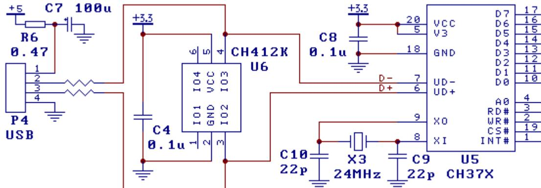
CH412K 可以用于 USB 高速信号的 ESD 保护, GND 直接连接到全局地, VCC 连接到 3.3V 电源电压, 并且由电容 C4 提供电源旁路。
