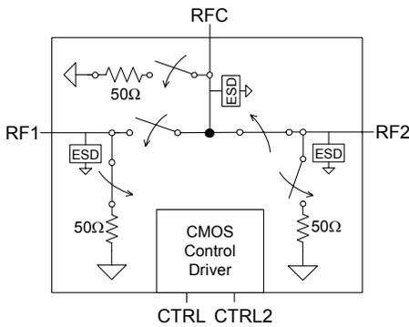
**50 Ω SPDT Absorptive UltraCMOS™
