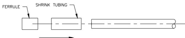
3. STRIP CABLE JACKET, BRAID AND DIELECTRIC TO SPECIFICATION LENGTHS.
