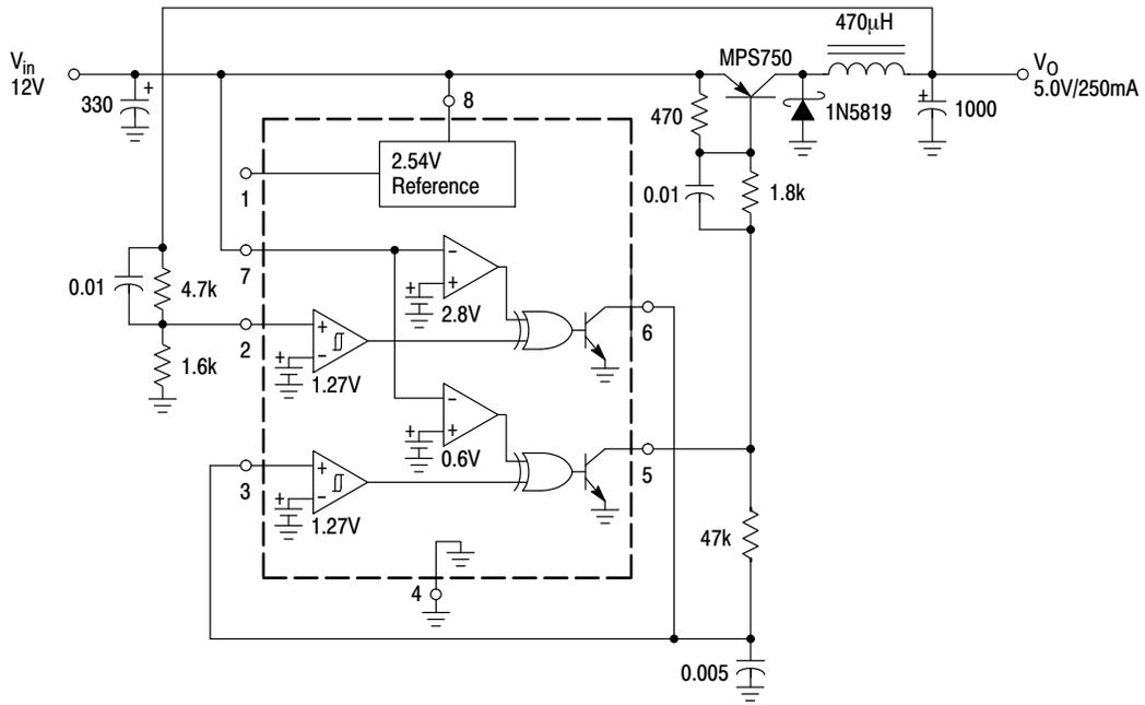
**Figure 27. Step-Down Converter**
