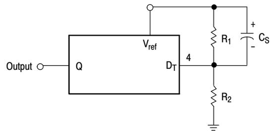
Figure 17. Soft-Start Circuit
