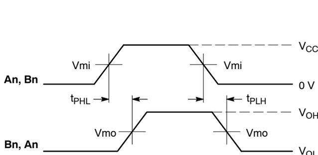
**WAVEFORM 1 – PROPAGATION DELAYS**
