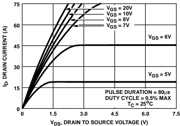
FIGURE 7. SATURATION CHARACTERISTICS
