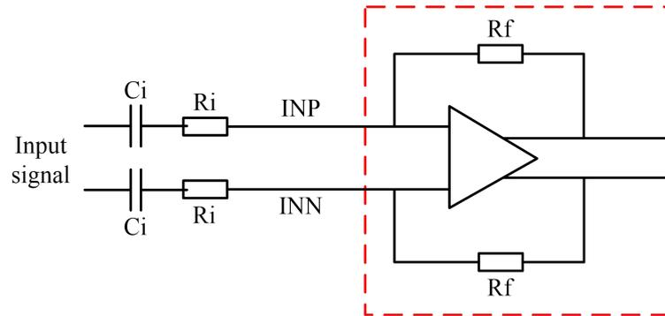
增益确定，也就是输入阻抗确定了之后，输入隔直电容  $C_i$  的选取尤为重要。一方面，电容值直接影响放大器的低频特性；另一方面，开关机 POP 声的抑制性能受电容的影响，如果耦合电容大，则反馈网络的延迟大，pop 声容易出现，相反较小的耦合电容可以减少该噪声。因此，输入电容  $C_i$  的选取要兼顾这两个方面。比如，增益为 22dB，总输入阻抗为 20k，-3dB 转折点  $f_c$  取 80Hz，由上计算公式得  $C_i=0.1\mu F$ 。
