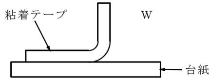
3-6. 引張り強度試験 : 10Nの力で引っ張った時、抜け、ズレのないこと。プッシュプルスケールでW方向に引っ張る。
